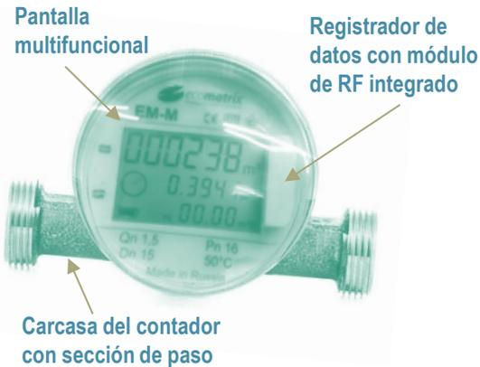
Los **contadores de agua EM-S tipo SingleJet** (DN15/20) para agua caliente y fría funcionan con alimentación autónoma y están equipados con módulos de transmisión RF integrados de la **plataforma EcoMatrix**. Están diseñados para la medición individual del consumo y la transmisión por radio en tiempo real de datos de caudal acumulado e instantáneo, así como de alarmas (**intervención magnética, control de temperatura ambiente, vandalismo, flujo inverso, etc.**).
