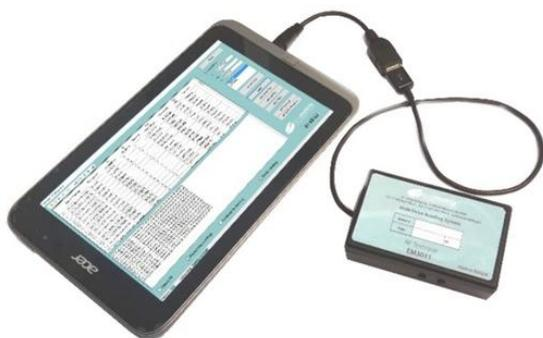
El sistema de lectura móvil WalkBy es una forma de recopilar datos de diversos dispositivos de medición, en la que el usuario se desplaza a pie o en vehículo por una ruta definida y recibe la información en una tableta o portátil conectado al Terminal RF EM3011 y con un software especializado.
