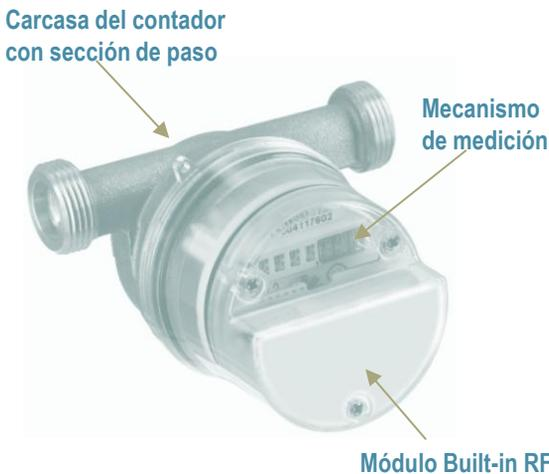
Los **módulos de transmisión por radio integrados (Built-in RF)** de la **plataforma EcoMatrix** están diseñados para su instalación en carcasas de contadores de agua fría/caliente tipo SingleJet de distintos fabricantes. El **módulo RF** mide y transmite en tiempo real, mediante un canal de radio, datos de consumo de agua y alertas por manipulación magnética.
